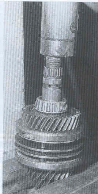
Dépose de l'ensemble roulement, pignon de 4e, synchro de 3e-4e et pignon de 3e de l'arbre primaire.
