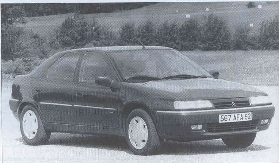
Les Xantia à moteur 2.1 turbo Diesel de 110 ch ont une face avant spécifique. Les ailes élargies, le bouclier enveloppant abritent un faux châssis avant plus large pour le moteur et la grosse boîte de vitesses ML5T et des roues de 15 pouces déportées vers l'extérieur de 20 mm.
