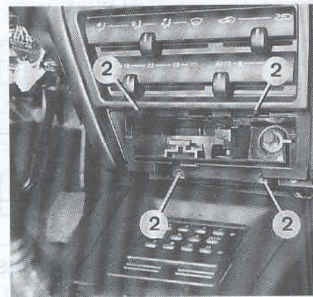
Dépose de la planche de bord. 2. Vis de fixation du support de cendrier.
