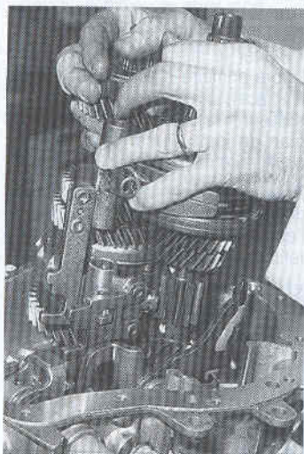
Dépose de l'ensemble pignonnerie fourchettes.
