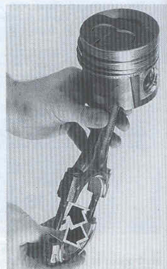
Assemblage bielle-piston. Flèche : orientation des ergots de positionnement.
