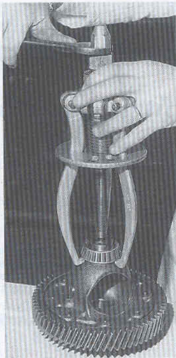
Dépose d'une goupille de maintien d'axe des satellites.
