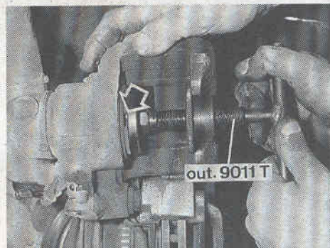
Enfoncement du piston avec l'outil 9011 T. La flèche indique la position de l'outil en fin d'opération.
