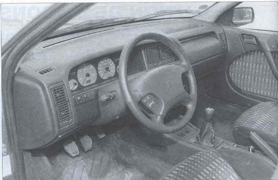
Dès les modèles 1995, les Xantia peuvent être pourvues d'un volant à quatre branches renfermant un «airbag» ou coussin gonflable de protection.
